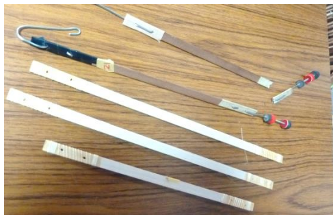
折れたトラッカー(上)と再制作したもの(下)
