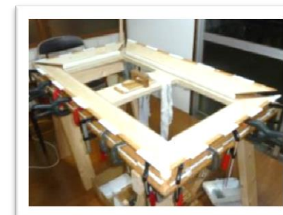
底板と側板が組み上がった
