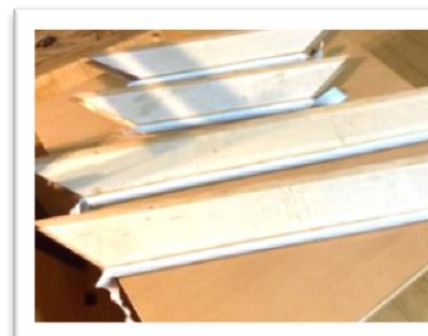
側板の空気漏れ革の貼付け
