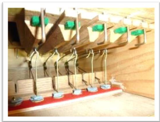
再組立を行った状態 製作したディスク・フックなどが使われている
